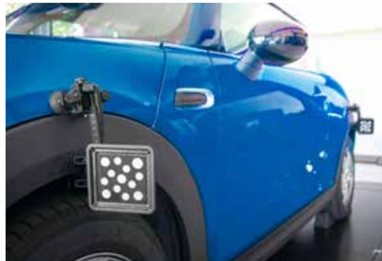
Keine manuelle Dateneingabe, schnellere Vermessung und höhere Genauigkeit dank unserer optionalen Targets zur Fahrzeugniveaumessung (TIP).
